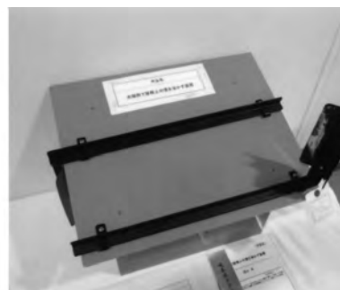
太陽熱で屋根雪を溶かす装置
