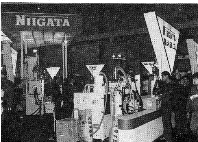
デジタルバルブ制御の精密射出成形機
