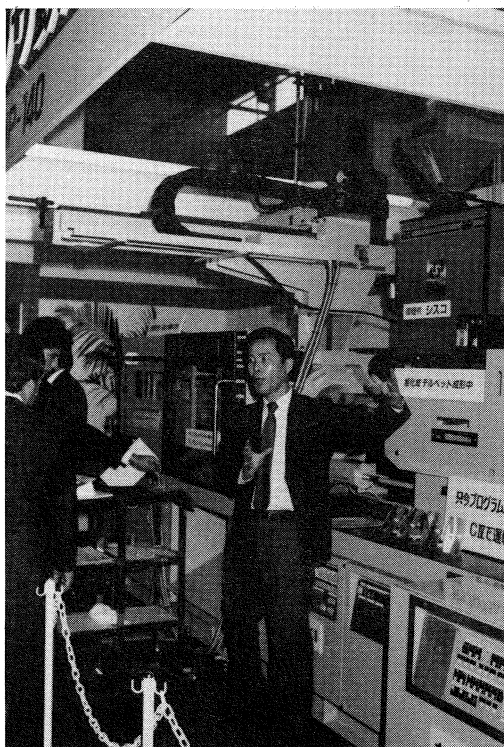
7段階の射出力・射出速度が得られる成形機
