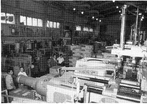
100台の成形機が24時間自動運転。これを3直3交替で管理し、合理化とコストを追求
