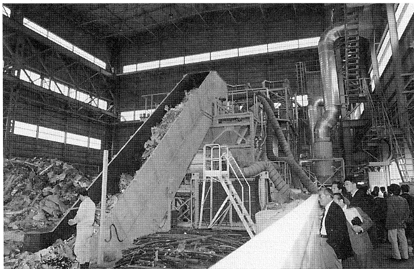
上は組合員一行、下は固形燃料製造装置の原料投入コンベヤー
