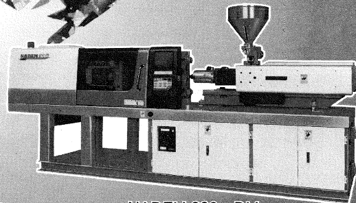
NADEM 800-DM (型締力800kN)オプション装着機
