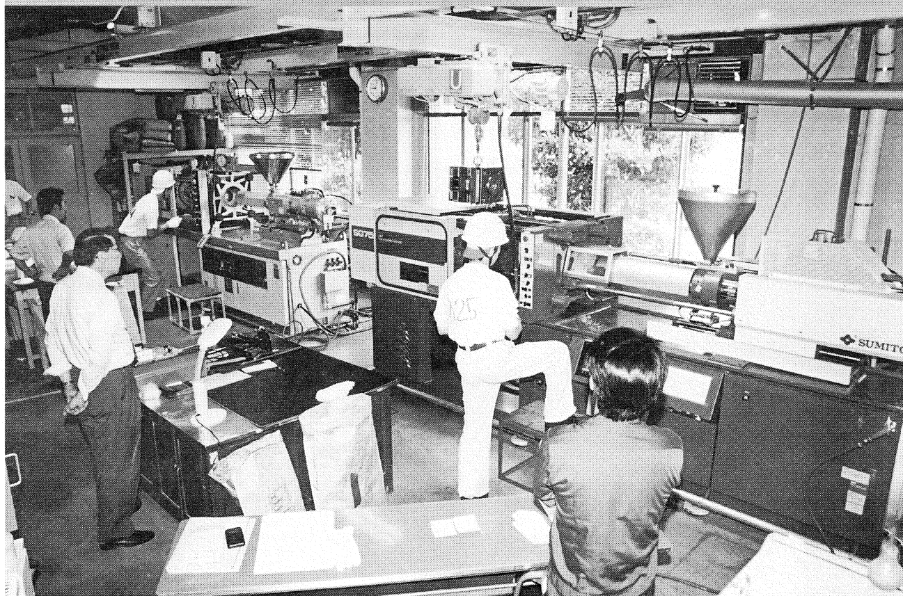
射出成形機2機を使用して実施した技能検定の実技試験
