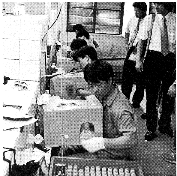
成形後の組立作業や塗装工程にはコンベアーラインはなく、人手による作業が中心だった
