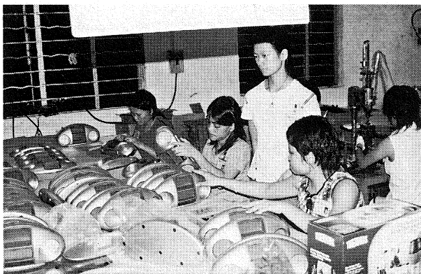
成形後の組立作業や塗装工程にはコンベアーラインはなく、人手による作業が中心だった
