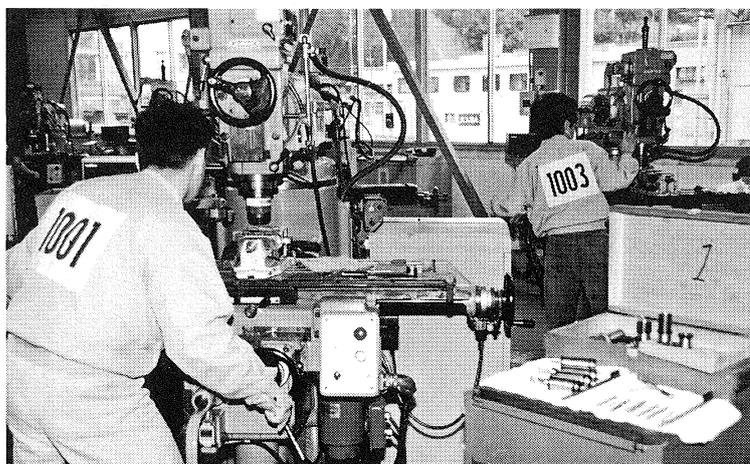
職業能力開発大学校で行った成形用金型製作の実技検定
