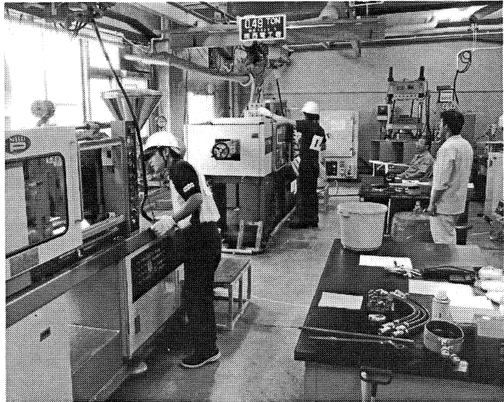
成形条件を細かく設定、樹脂を投入して成形開始
