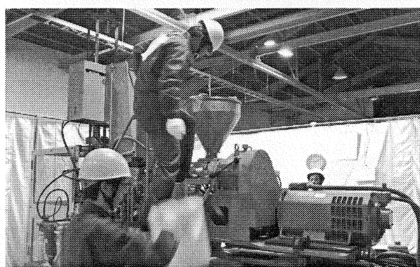
成形機への金型取り付け作業と樹脂の投入
