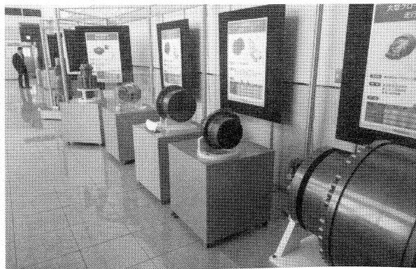
垂井工場の油圧関連製品の数々。左は風力発電機用の駆動装置。右は建機用の走行ユニット
