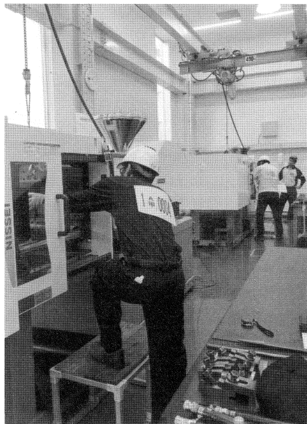
作業開始。初期設定して金型を取り付ける
