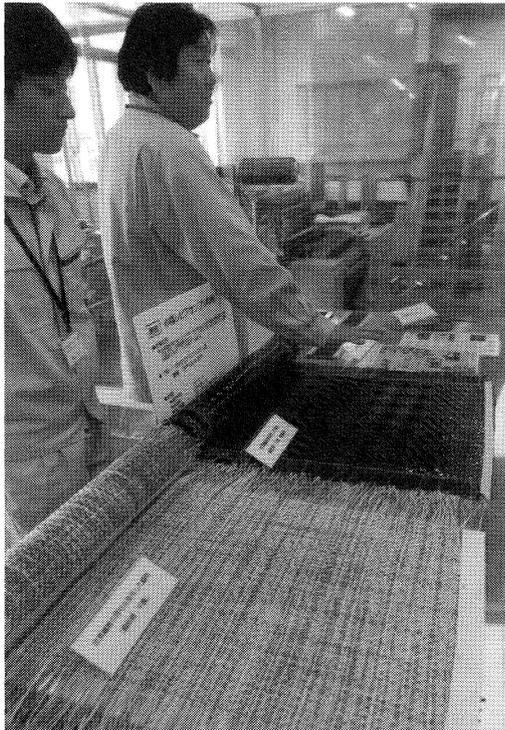
CFRPの素材となる炭素繊維織物試作品
