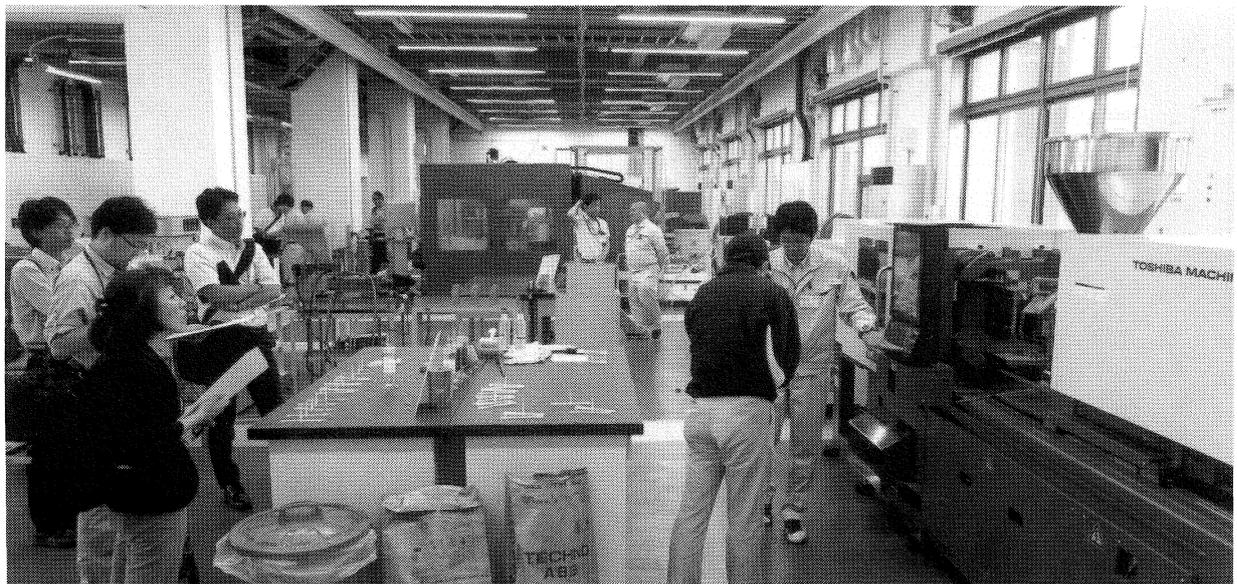
技術開発本部棟内の全景と試作・金型トライ用の新設プラスチック射出成形機(東芝75㍓)
