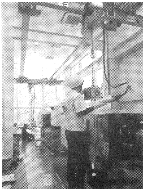
成形機を起動設定し、慎重にクレーンを操作
