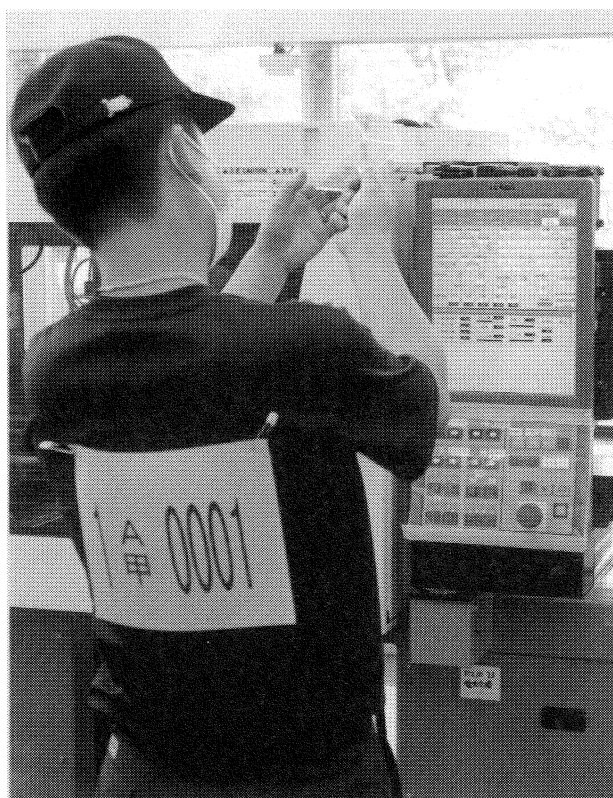
成形不良の改善に苦心、デジタル盤を調整
