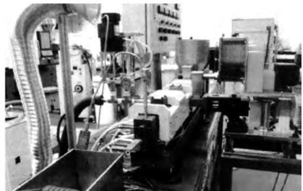
新規導入した複合材料試験加工機（2軸押出機）樹脂中に異種樹脂を混練しサンプルを作成する
